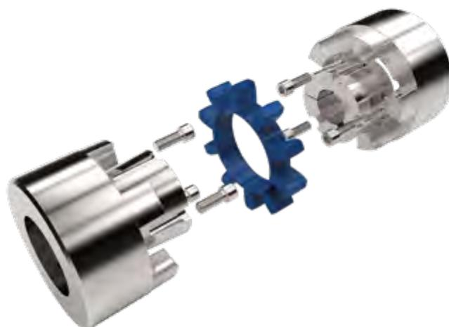
La sustitución de la estrella de acoplamiento se lleva a cabo desplazando axialmente las mitades del acoplamiento sin necesidad de desmontar las máquinas conectadas.
